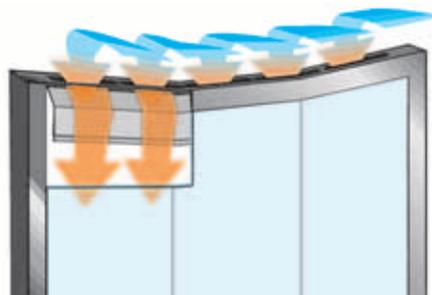
**C** **aria per la post-combustione** prearata, è immessa dal cielo del focolare
