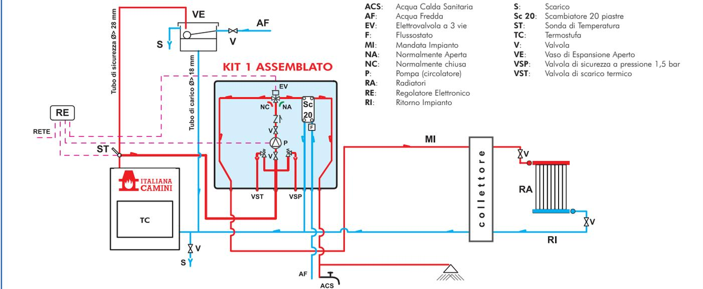
Impianto idraulico Termostufa senza produzione di Acqua Calda Sanitaria + Caldaia murale
