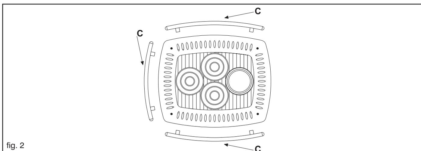
Togliere la cornice dalla stufa e posizionarla capovolta su un piano; prendere la confezione dei corrimani che si trova all'interno del focolare. Svitare dai supporti dei corrimani le viti che servono per il fissaggio alla cornice. Inserire le viti nei fori predisposti nella cornice, puntare le viti nei supporti di ogni spezzone di corrimano **C** e serrare con una chiave a brugola da 5 mm. (fig. 2)
