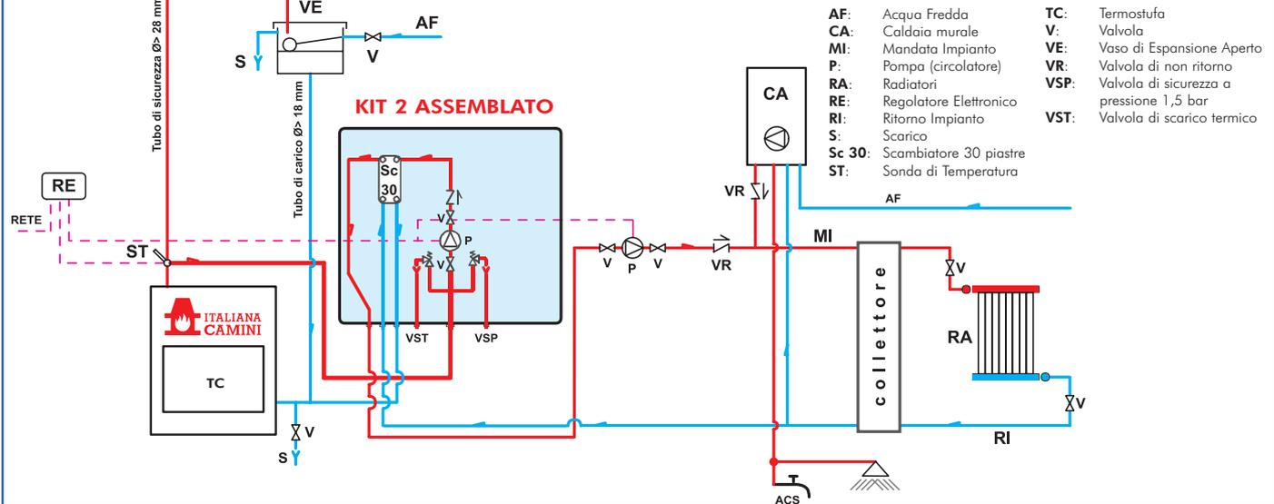
Impianto idraulico Termostufa con produzione di Acqua Calda Sanitaria + Caldaia murale
