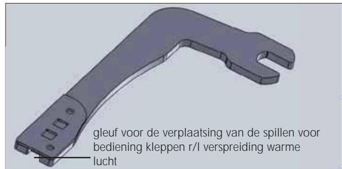
gleuf voor de verplaatsing van de spijlen voor bediening kleppen r/l verspreiding warme lucht
