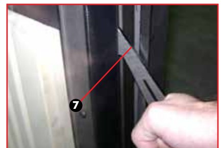
Figura 4: bloccaggio portellone chiuso (ruotare il nottolino di 90°)
