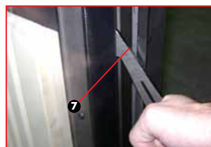
Figura 4: bloccaggio portellone chiuso (ruotare il nottolino di 90°)
