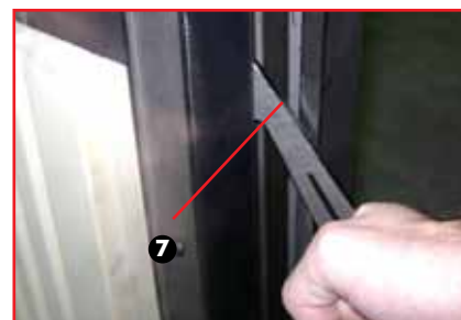
Abbildung 4: Blockierung der geschlossenen Tür (die Klinke um 90° drehen)
