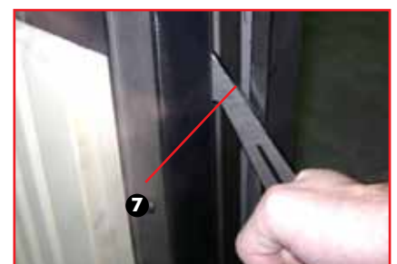
Figure 4: blocage porte fermée (tourner la gâchette de 90°)
