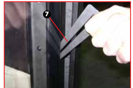
Figura 3: bloccaggio portellone aperto (ruotare il nottolino di 90°)
