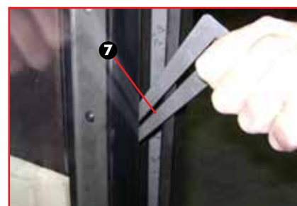
Abbildung 3: Blockierung der offenen Tür (die Klinke um 90° drehen)
