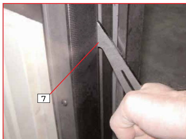
Figura 4: bloqueo puerta cerrada (rotar el gatillo unos 90°)
