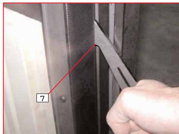
Figuur 4: vergrendeling gesloten deur (verankering 90° draaien)
