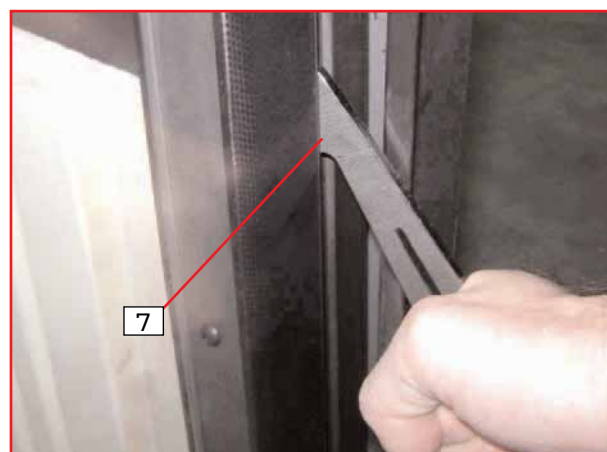
Figure 4 : blocage porte fermée (tourner la gâchette de 90°)
